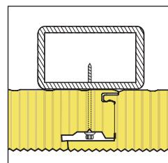
La perfetta configurazione del giunto rende piacevole e uniforme la superficie dell'involucro edilizio, e consente al pannello di abbattere considerevolmente i ponti termici che, come è noto, sono causa di dispersione energetica e formazione di condensa.
